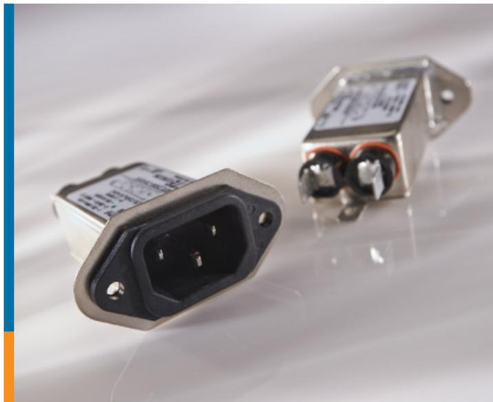
TE Connectivity (TE) は、Corcom EJT シリーズの IEC インレットフィルタの性能を向上させた、高周波用途向けの Corcom EJT パワーインレットフィルタをリリースします。本製品は、IEC320-C14 タイプのフランジを拡張し、潜在的な隙間を通過する放射高周波 (RF) 量を低減します。通常の EMI フィルタが 30MHz 以下の周波数を遮断するように設計されているのに対し、EJT シリーズは EMI フィルタの性能を 1GHz まで向上させます。30MHz を超える周波数を減衰させるユニークな回路設計と内部構造技術が EJT シリーズの性能の向上に貢献します。
