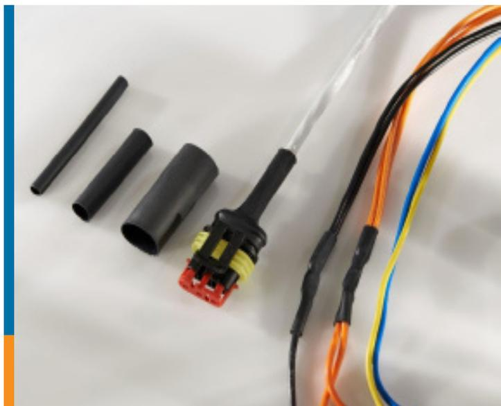
TE Connectivity (TE) は、UL VW-1 に適合する DWFR 熱収縮チューブを新たにリリースします。DWFR は、ポリオレフィン製ジャケットと接着剤付きの熱可塑性内壁からなる高難燃性・高収縮率の二層構造チューブです。DWFR は、UL 224 VW-1 に適合する TE 初の二層構造チューブであり、優れた電気絶縁性と耐湿用シール機能を提供します。
