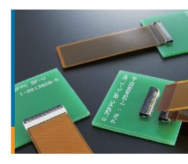
TE Connectivity(TE)の 0.25mm ファインピッチ FPC コネクタは、峡ピッチかつ、低背型の相互接続ソリューションに対する要求を満たすために開発され、37、41、45 および 51 極の製品がラインアップされています。斜め挿入方式により、PCB 上のコネクタの配置に制約がなくなり、コネクタの手前に別のコンポーネントを配置することが可能になりました。下部端子とバックフリップロックアクチュエータを採用したコネクタの設計が PCB の保持力を高めます。 0.25mm ファインピッチ FPC コネクタに加え、高さ (0.9mm ~ 1.2mm)、コンタクト位置(上部端子、下部端子) およびフリップロックタイプ(フロントまたはバック)の異なる 25 極から 71 極までの 0.3mm ファインピッチ FPC コネクタも取りそろえています。
